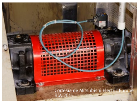
Ventilador: FAG SmartCheck está montado en el rodamiento del eje
