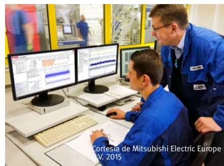
El sistema SCADA visualiza los datos de vibraciones y la información del estado de los sensores en tiempo real
