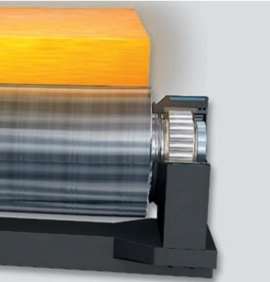
El nuevo rodamiento de rodillos cilíndricos de FAG combina las ventajas de un rodamiento de rodillos cilíndricos sin jaula con las características de un rodamiento oscilante de rodillos. Esto significa una elevada capacidad de carga radial, movimiento axial ilimitado y compensación de desalineación angular. Todas estas características se combinan en un rodamiento que puede montarse rápida y fácilmente. Este rodamiento libre perfecto ya ha demostrado su capacidad en muchos laminadores.
