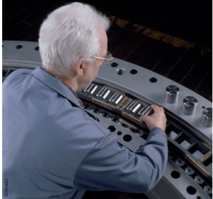
Figura 1 Reacondicionamiento de un rodamiento para una tuneladora, montaje de los elementos rodantes
