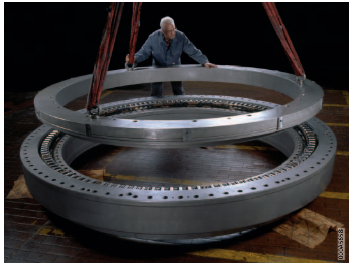
Figura 9 Montaje de un nuevo anillo del rodamiento
