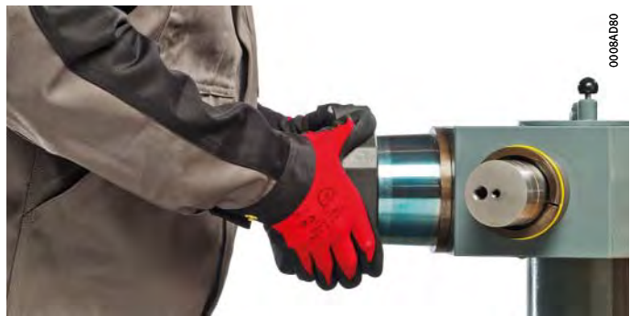
Figura 5 Control con azul de prusia y un aro calibre cónico
