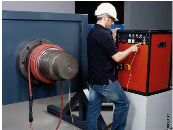
Figura 10 Desmontaje de anillos interiores mediante inductores flexibles
