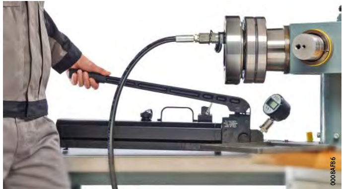
Figura 14 Desmontaje hidráulico con asientos cónicos
