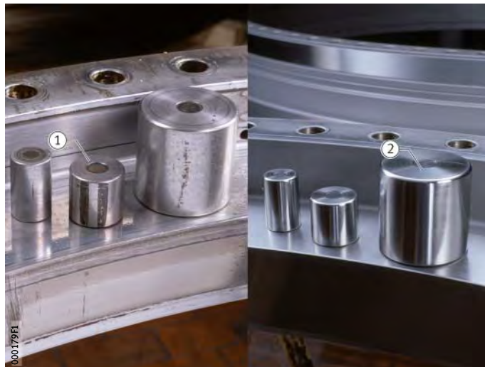
Figura 3 Las pistas de rodadura y los rodillos del rodamiento antes y después del reacondicionamiento
