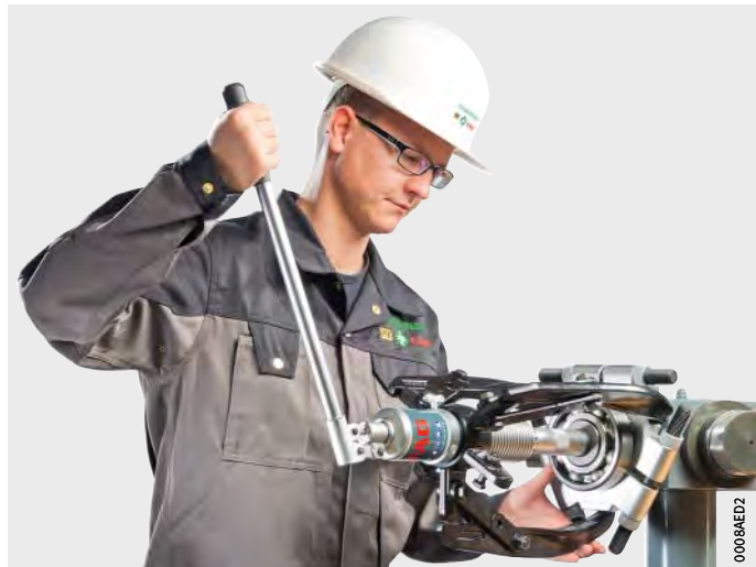
Figura 1 Desmontaje mediante dispositivos de extracción
