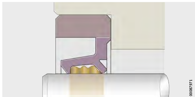
Figura 5 Llenado de grasa entre el labio obturador y el labio de protección
