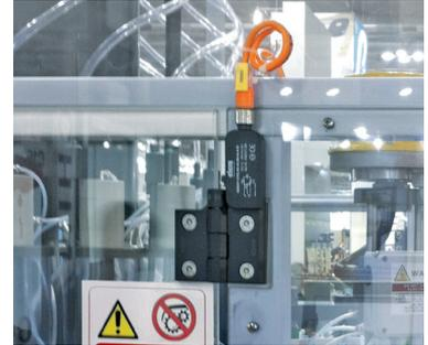
Aplicación de bisagra CFSQ con interruptor de seguridad incorporado.
