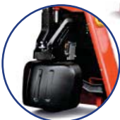
Protección del sistema de elevación y tracción
