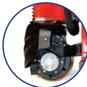
Motor tracción 0,65 kW Rueda Ø210x70mm
